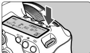
Active (☀️6)/desactive a iluminação do painel LCD carregando no botão <☀️>. Durante uma exposição “bulb”, se carregar no botão do obturador até ao fim, desactiva a iluminação do painel LCD.
