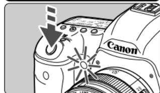
Se não olhar através do visor quando carregar no botão do obturador, coloque a tampa da ocular (p.185). Se entrar luz dispersa no visor quando estiver a tirar a fotografia, pode afectar negativamente a exposição.
