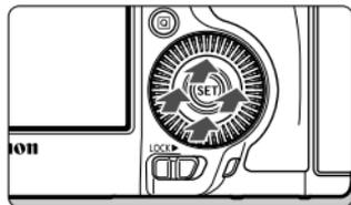
Depois de carregar no botão
